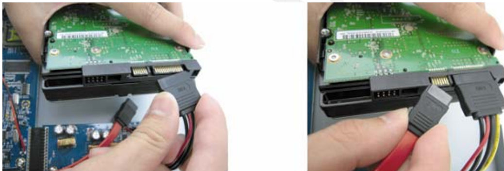
Schritt 3: Schließen Sie den Stromanschluss & Datenbusanschluss an.
