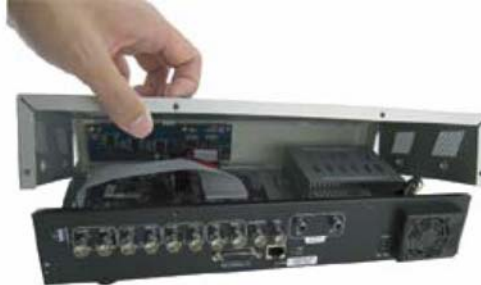
Schritt 1-2: Entfernen Sie die obere DVR-Abdeckung
